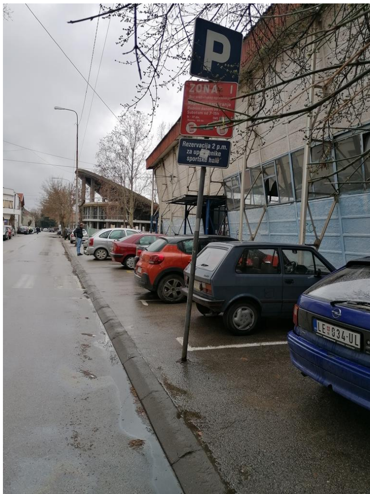
Слика 3.4 Пример неправилно обележених паркинг места и оштећене вертикалне сигнализације у улици Доситеја Обрадовића
